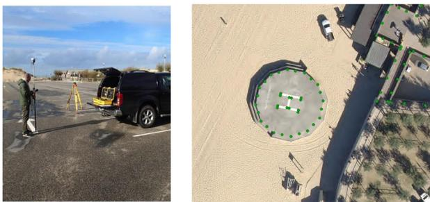
4 Qualification altimétrique du nuage de point et du MNT. Et planimétrique pour l'orthophotographie au moyen de l'erreur quadratique moyenne
