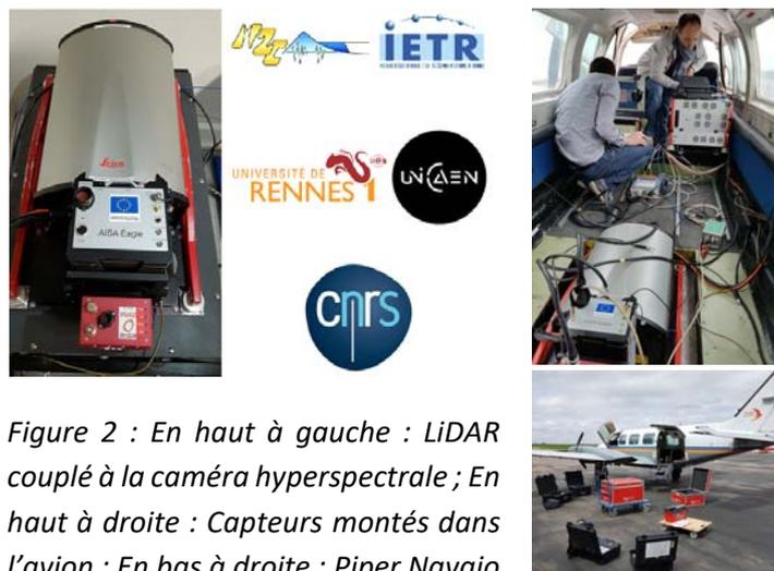
Figure 2 : En haut à gauche : LiDAR couplé à la caméra hyperspectrale ; En haut à droite : Capteurs montés dans l'avion ; En bas à droite : Piper Navajo (Pixair Survey) utilisé pour ce vol
