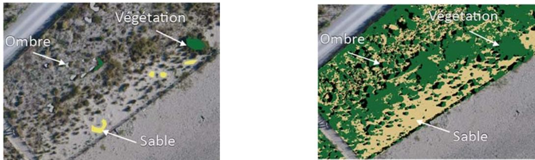
Figure 1: Exemple du résultat obtenu suite à la classification supervisée
