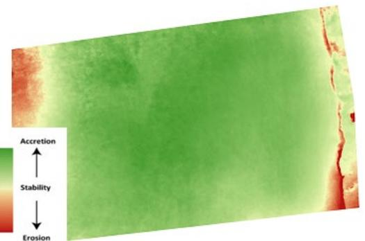
**Figure 6 : Exemple d'un DMNV sur le secteur de Grand Village, le différentiel est effectué après le passage de la "marée du siècle" de mars 2015.**
