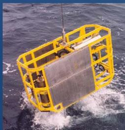
▲ Fig. 2 : Caméra tractée Scampi
