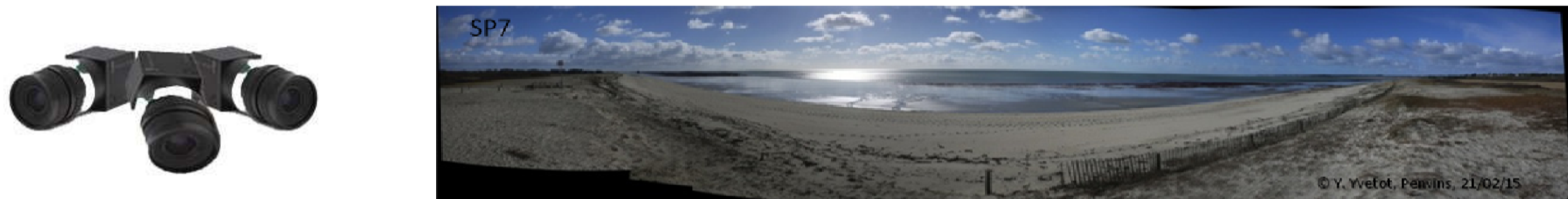
Caméras disposées à 120° et image panoramique résultante
